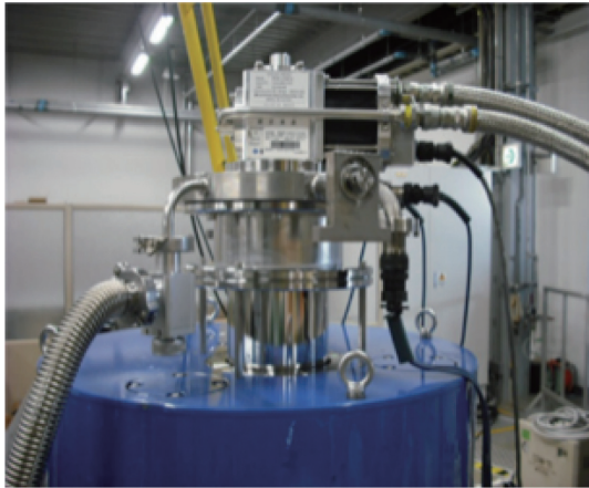
图 14 MRI 系统轴向磁场下的冷头
