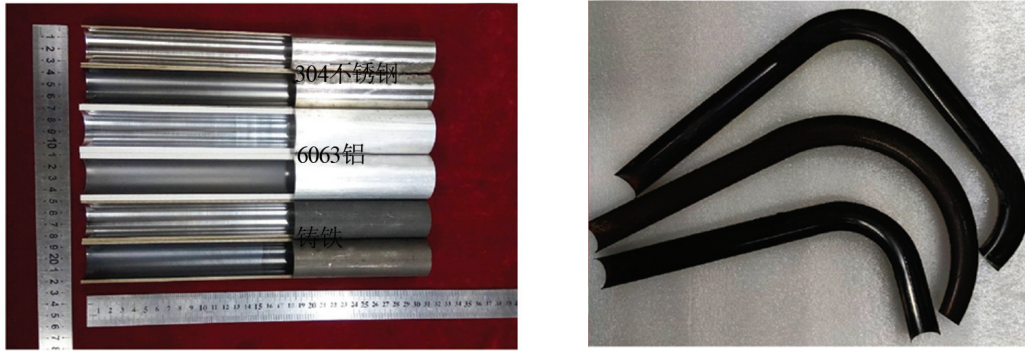
(a) 沉积DLC薄膜前后的 SS304不锈钢、6063Al和铸铁管 (b) 沉积了DLC薄膜的直角管
